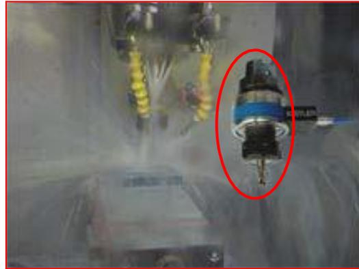
**Fig IV.13** Montage dynamomètre rotatif.
