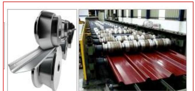
**Fig I.19** Profilage à froid
