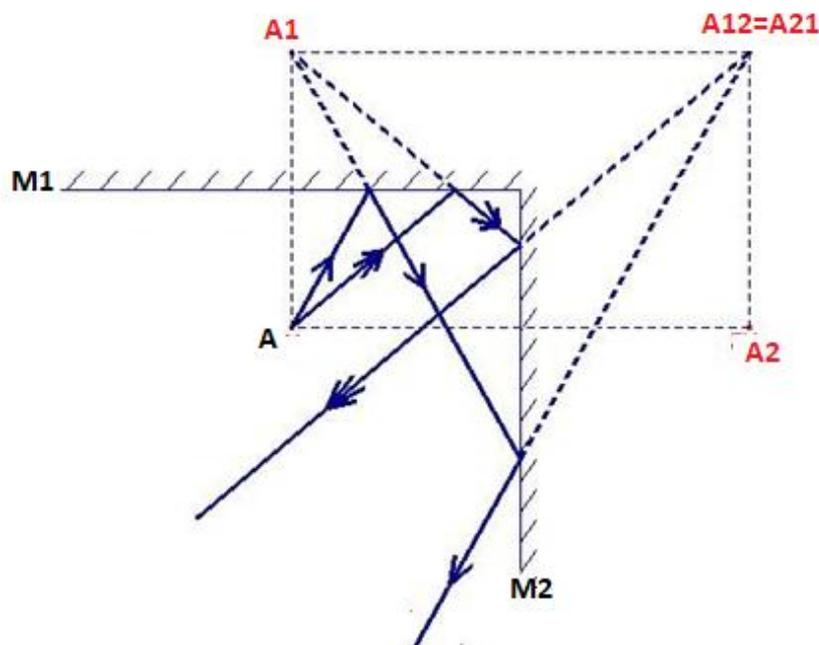
On constate pour construire l'image de A par rapport au miroir M1, on a pris deux rayons issus de A. De la même manière pour l'image de A par rapport au miroir M2. Il faut noter que les rayons de ce dernier ne sont pas présentés sur la figure.
