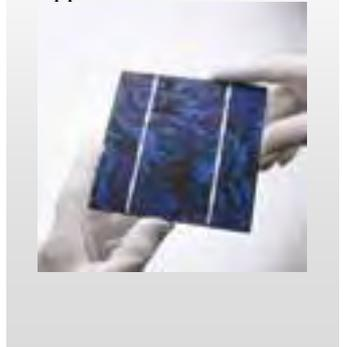
Les photons de la lumière solaire arrachent des électrons aux atomes de silicium et créent des charges positives négatives.
