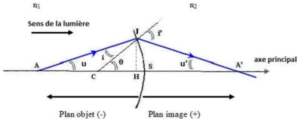
Soit un objet **réel** **A** se trouvant sur l'axe optique, alors son image **A'** se trouve sur l'axe optique
