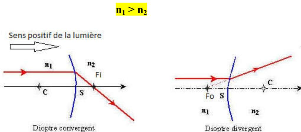
Les rayons lumineux issus parallèles convergent vers un seul point  $F_i$ , dans le dioptré convergent. Tandis que, dans le dioptré divergent, les rayons issus parallèles divergent et leur prolongement passe par un point  $F_o$ . Les points  $F_i$  et  $F_o$  seront définis ultérieurement.
