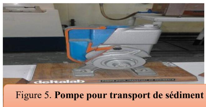
Figure 5. Pompe pour transport de sédiment
