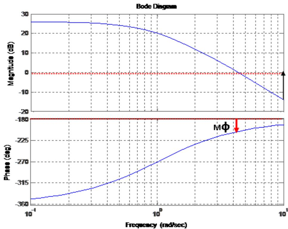
Le système est instable en BF car  $M_G > 0$  et  $M_\varphi < 0$
