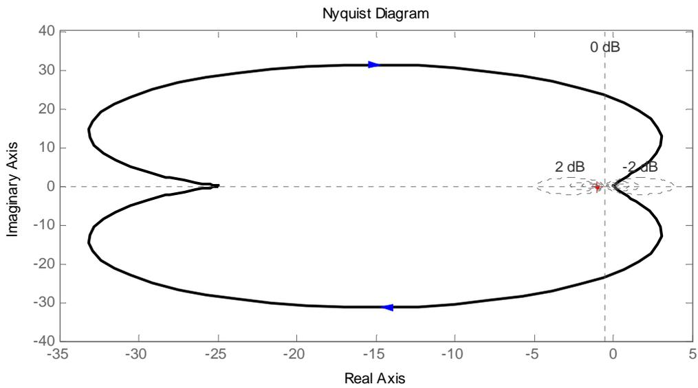
Le système n'est pas stable en boucle fermée
