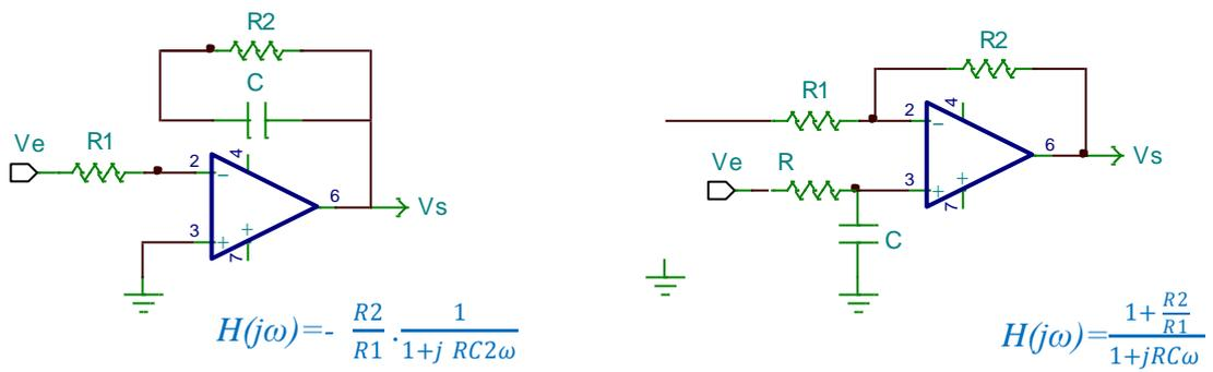
Figure 46- Exemples de filtres Passe Bas
