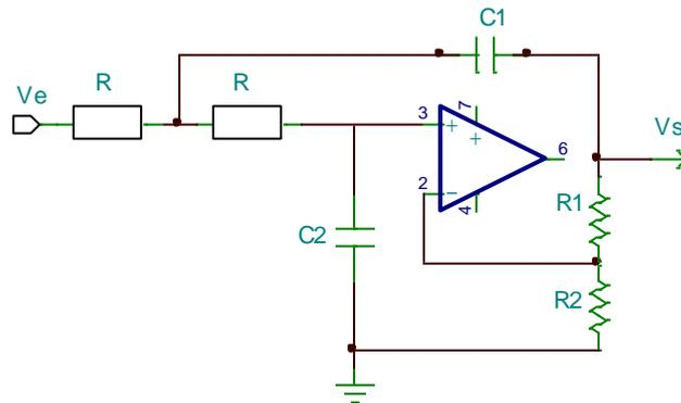
$$\frac{Vs}{Ve} = \frac{Y1 \cdot Y3}{(Y1 + Y2)(Y3 + Y4) + Y3(Y4 - Y2 \cdot KA)}$$
