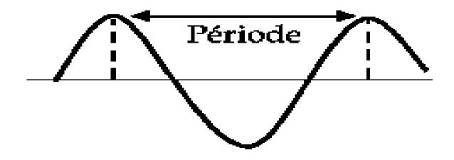
**Amplitude** : correspond à la moitié de la différence entre les valeurs maximale et minimale observées au cours d'une période
