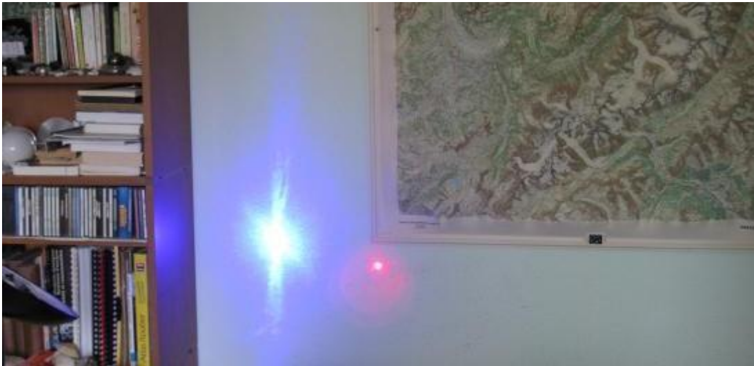
Diode laser bleu et lentille très légèrement désaxée
