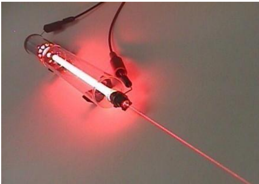
Laser Hélium Néon (He-Ne) à 633nm
