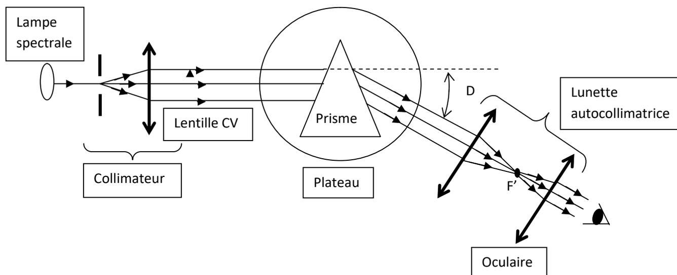
Le goniomètre permet de mesurer des angles de déviations  $D(i)$  en fonction de l'angle d'incidence. En se plaçant au minimum de déviation, on en déduit l'indice du prisme par la relation :
