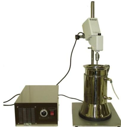
Figure12 : Extraction par Ultrasons
