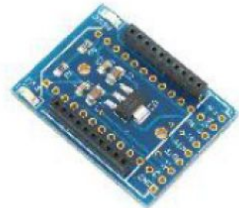
Interface simple avec régulateur 5V/3,3V
