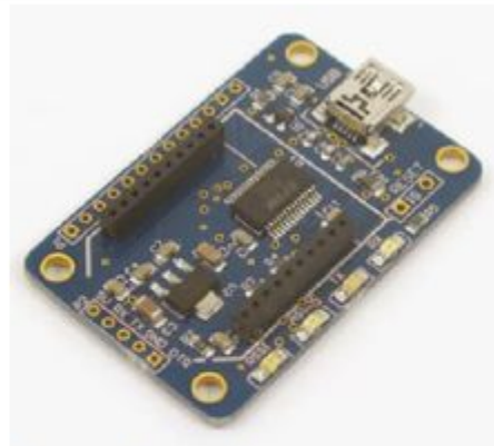
Interface de programmation USB alimentée par câble USB
