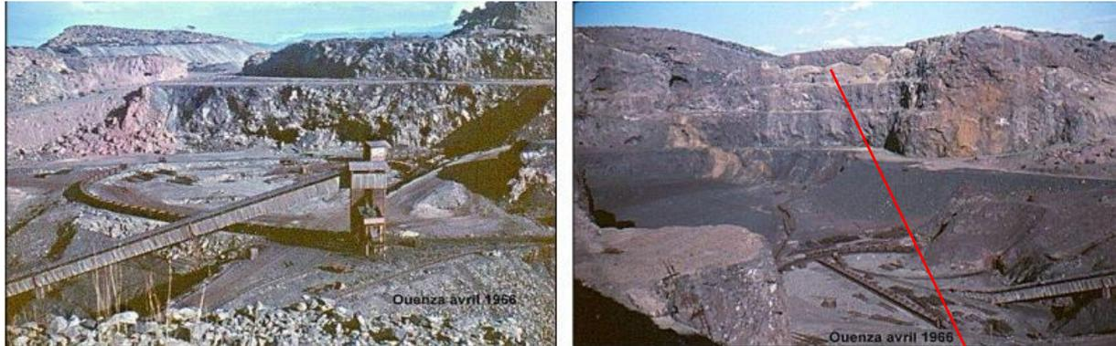
Fig .2 : Mine à ciel ouvert de l'Ouenza Gradins d'exploitation
