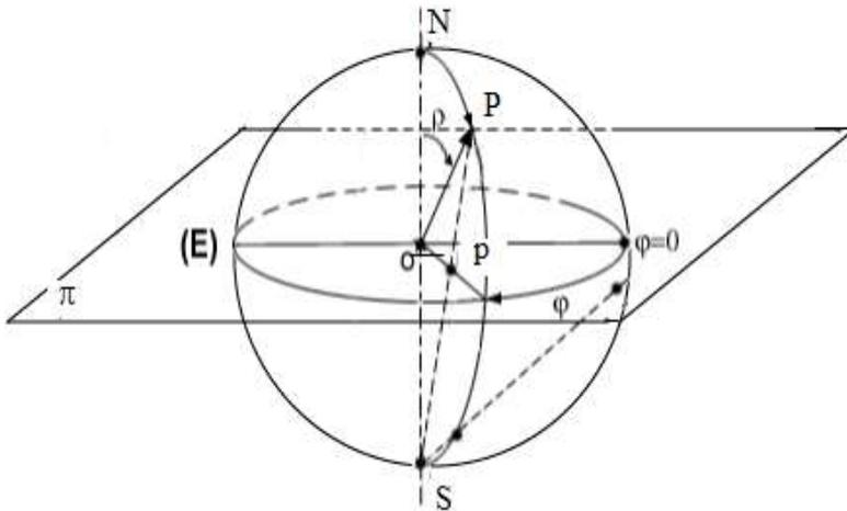
Fig.III-9 : Principe de la projection stéréographique
