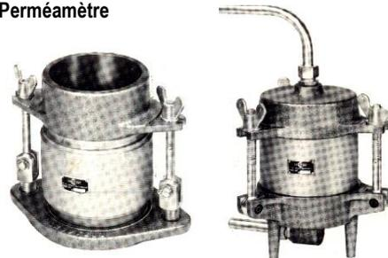
Le perméamètre peut être du type Proctor ou moule CBR. Son fond et son couvercle (amovibles) sont munis chacun, d'une pierre poreuse et d'un ajutage. L'ajutage du fond permet l'arrivée de l'eau et celui du couvercle, la sortie.
