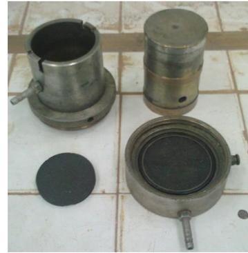
**Figure 6/** Détails du moule oedométrique de Terzaghi
