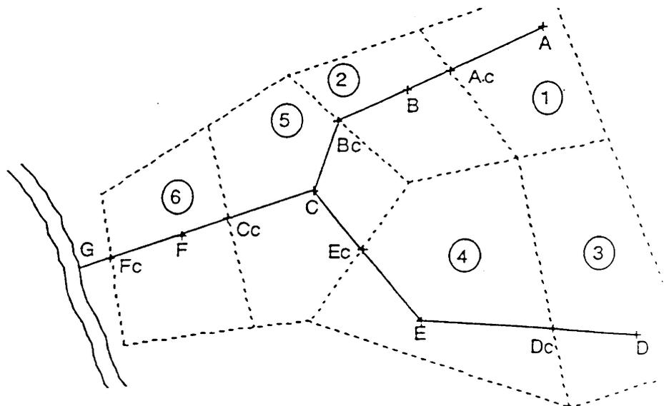
Au point A<sub>c</sub> : la surface drainée A<sub>1</sub> correspond au bassin versant B<sub>1</sub>, générant le débit de pointe Q<sub>p1</sub>, qui permettra le choix du diamètre sur le tronçon AB.
