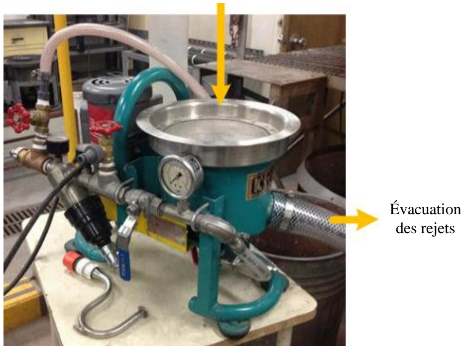
Figure 3.4 : Séparateur gravimétrique Knelson du laboratoire de l'Université Laval, © Jean-François Boulanger, 2016
