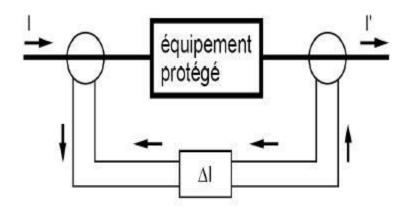
Figure 7.4 : Protection différentielle :
