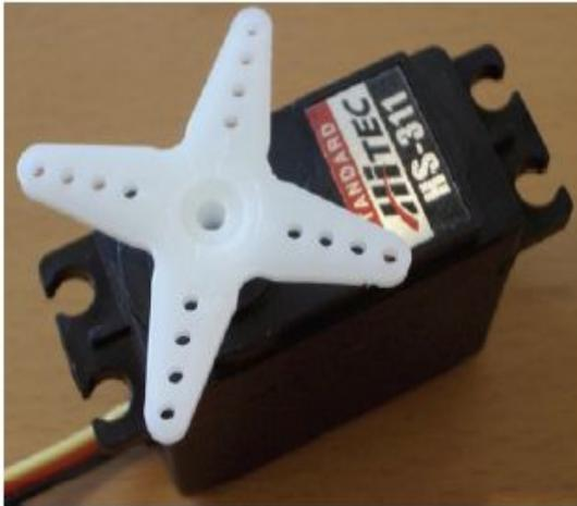
Le servo-moteur est un moteur (rotatif) qui peut effectuer des rotations très précises (dans une portion de tour seulement) et en un certain nombre de pas ( de micro-déplacements). Il y a toutes sortes de servo moteurs.. Un des avantages des servo moteurs est sa possibilité de maintenir avec force une position donnée. On peut piloter des rotations avec l'Arduino, quelques fois directement avec la carte si le moteur n'est pas trop puissant, sinon en passant par un montage associé.
