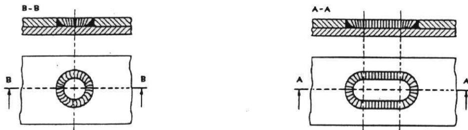
Figure 17 : Soudure en entaille
