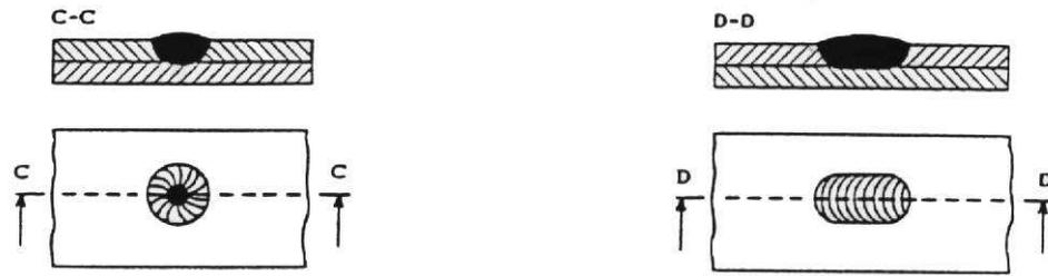
Figure 17 : Soudure en bouchon
