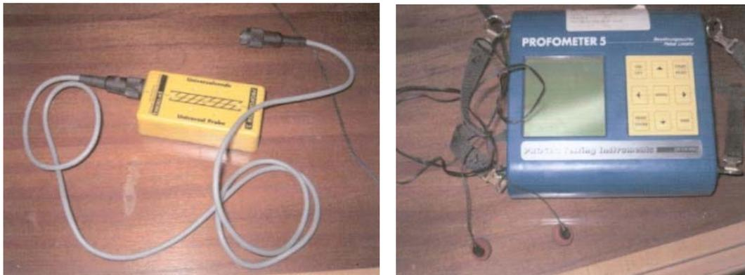
Fig 4 : Pachomètre, appareil de détection des armatures d'acier dans le béton
