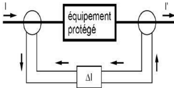
Figure7.4 : Protection différentielle :
