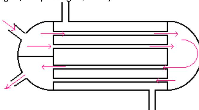
Figure 8.3 - Echangeur à deux passages
