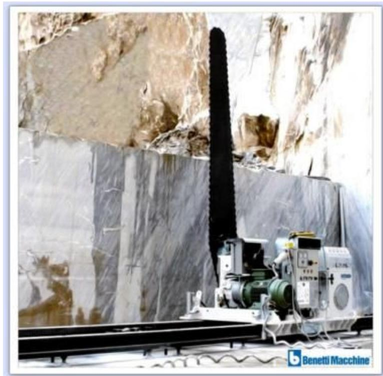
Pour le sciage, des haveuses rouilleuses peuvent remplacer efficacement le fil diamanté et éviter l'emploi de l'explosif.
