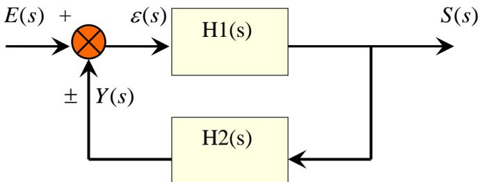
La connexion en opposition parallèle est composée principalement par une chaîne d'action et une chaîne de réaction (positive ou négative).
