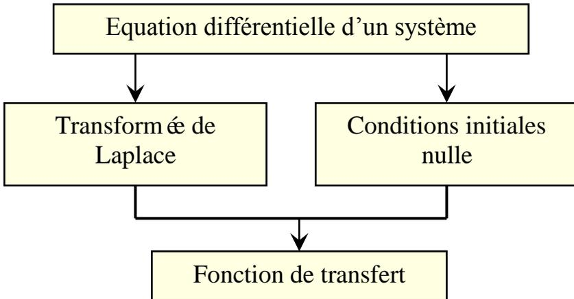
Ainsi, le quotient des grandeurs de sortie et d'entrée exprimées dans l'espace de Laplace est appelé fonction de transfert. Sa valeur est obtenue par le quotient des polynômes en  $s$  formés par les coefficients de l'équation caractéristique.
