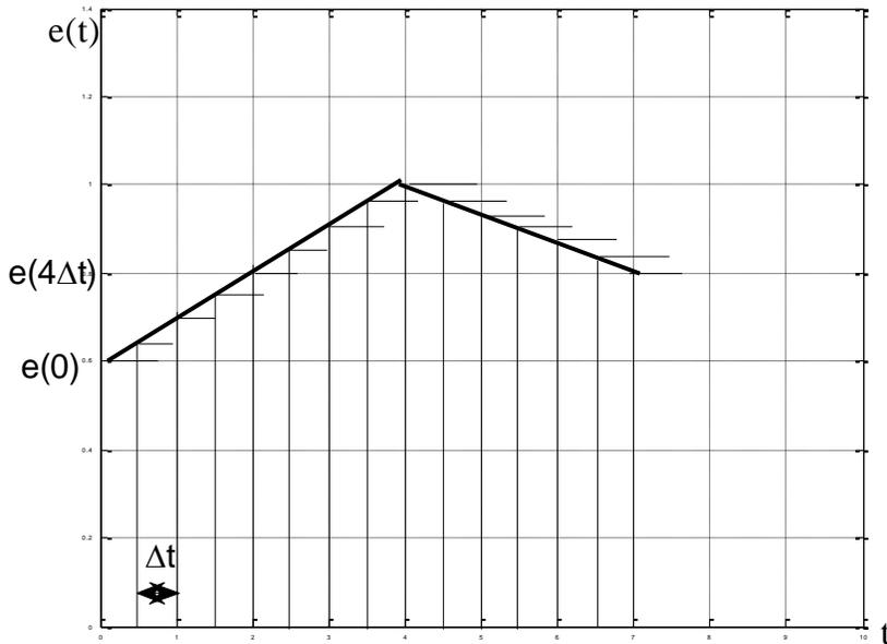
La première impulsion est  $\delta(t)$  d'une largeur  $\Delta t$  et d'une hauteur  $e(0)$ . La seconde impulsion est  $\delta(t - \Delta t)$  d'une largeur  $\Delta t$  et d'une hauteur  $e(\Delta t)$ , etc..
