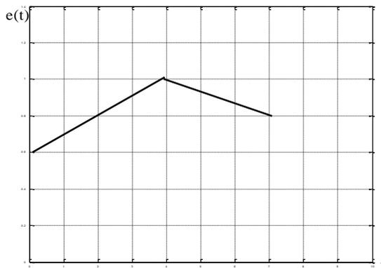
En utilisant, le principe de superposition, il est possible de diviser le signal d'entrée  $e(t)$  en un train d'impulsions rectangulaires d'une durée  $\Delta(t)$ , puis définir l'entrée  $e(t)$  par une somme de toutes ces impulsions.
