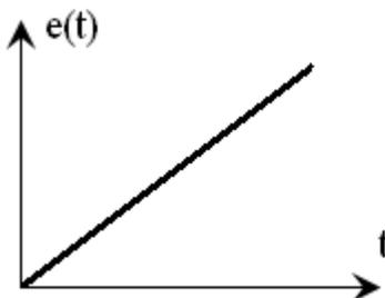
On utilise généralement la rampe pour tester les systèmes asservis lorsque l'entrée (ou la référence) est une fonction variable dans le temps. On dit que le système est soumis à une entrée rampe de pente unitaire. Si elle est retardée d'une valeur  $\tau$ , on aura.
