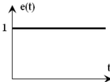
Généralement, cette fonction n'est définie que pour  $t = 0$ . Elle est souvent utilisée pour tester les systèmes asservis lorsque l'entrée (ou la référence) est une constante. Parfois, on l'appelle aussi fonction de Heaviside ou fonction d'existence.
