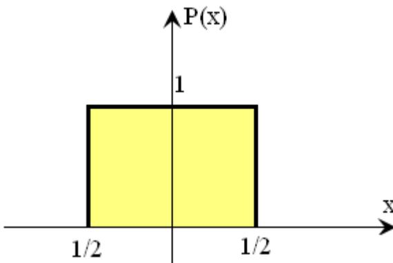
Pour obtenir une fonction sous forme d'une impulsion unité centrée à l'origine et d'aire égale à l'unité, on diminue au fur et à mesure la base  $x$  tout en augmentant la hauteur  $P(x)$ . Pour une valeur de  $x$  qui tend vers zéro (origine : ponctuel), on aura  $P(x)$  qui tend vers l'infini, car  $P(x)$  est inversement proportionnel à  $x$ . Par conséquent, l'intégration de cette fonction égale à l'unité.
