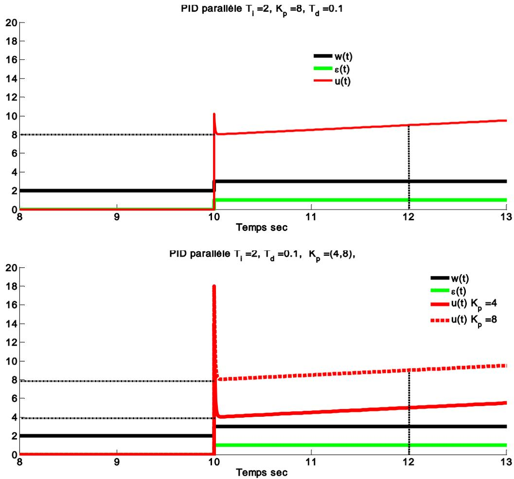
Figure 2.30: Réponse indicielle d'un régulateur PID parallèle.
