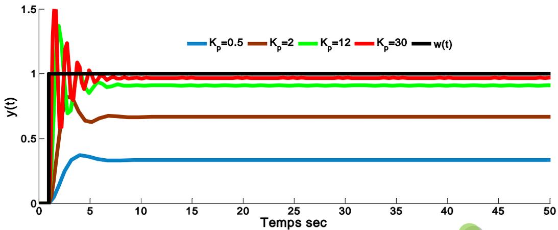
**Figure 2.17 :** Réponse indicielle d'un système du deuxième ordre bouclé avec régulateur proportionnel. Les deux figures ( **Fig 2.16, Fig 2.17**) montrent que l'augmentation de  $K_p$  diminue l'écart en régime statique, et augmente la rapidité en régime dynamique tant que le système n'est pas trop oscillatoire.
