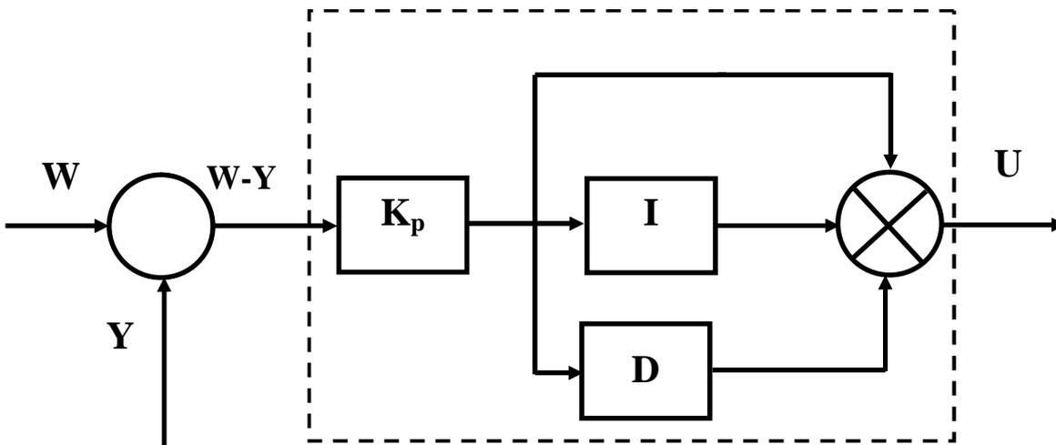
Figure 2.34: Structure mixte d'un Régulateur P.I.D.
