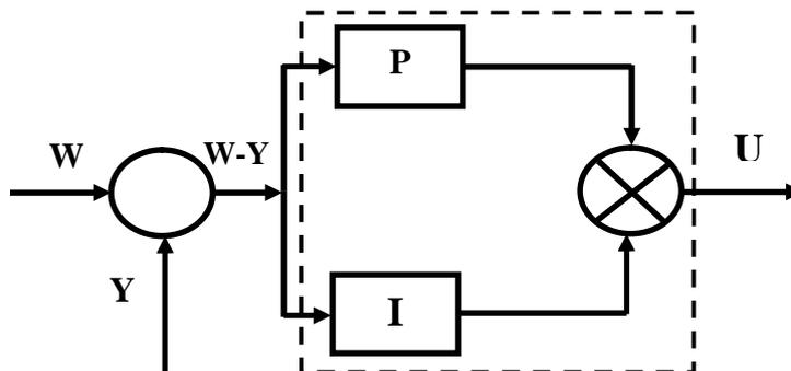
Figure 2.25 : Structure parallèle d'un Régulateur P.I.
