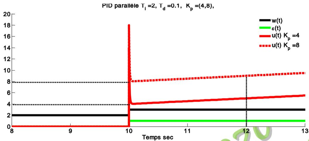
Figure 2.38: Identification de la structure parallèle d'un Régulateur P.I.D.
