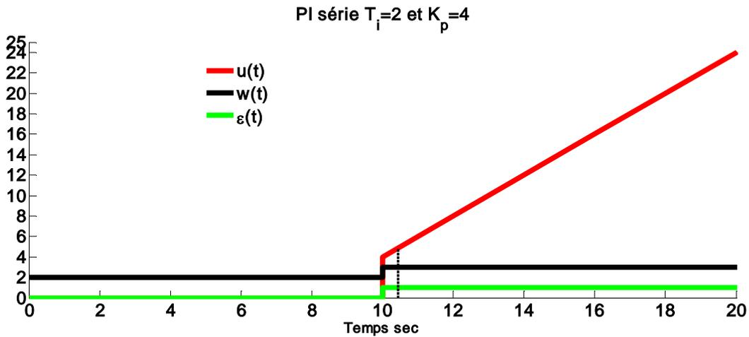
Figure 2.28: Réponse indicielle d'un régulateur PI série.
