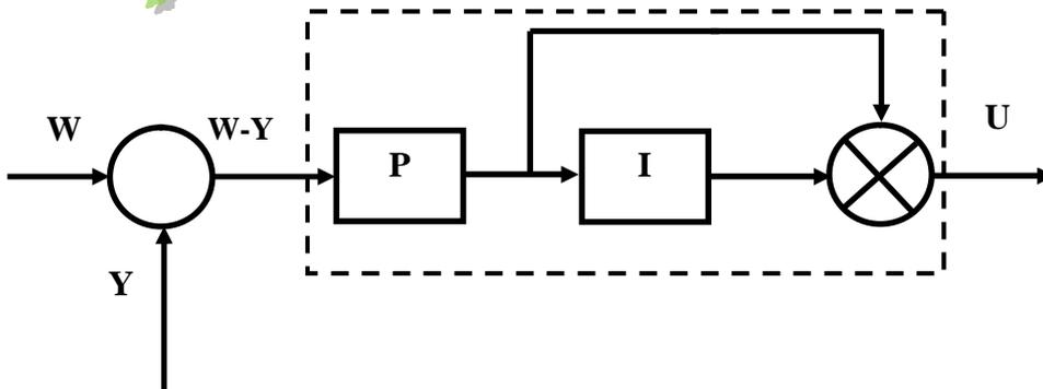
Figure 2.27: Structure série d'un Régulateur PI.
