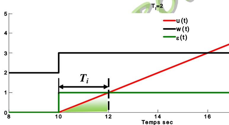
Figure 2.19 : Sortie d'un régulateur intégral pur.
