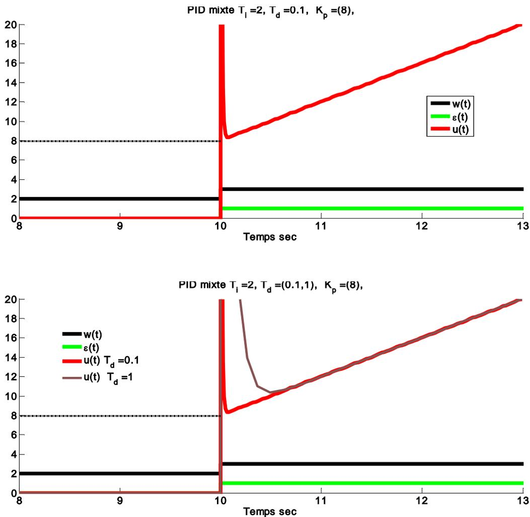
Figure 2.35: Réponse indicielle d'un régulateur PID parallèle.
