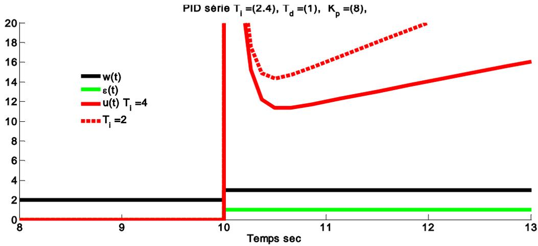
Figure 2.31: Réponse indicielle d'un régulateur PID série.
