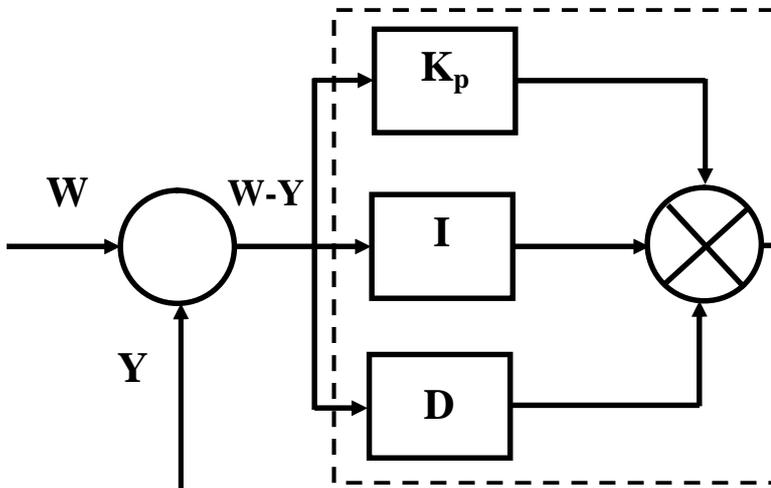
Figure 2.32: Structure parallèle d'un Régulateur P.I.D.
