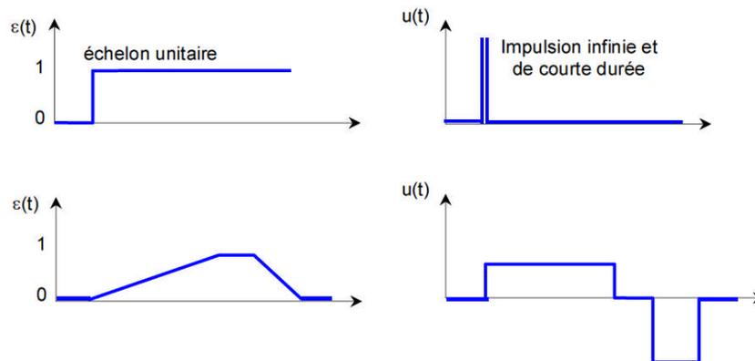
**Figure 2.22 :** Réponse indicielle et réponse en à une rampe d'une action dérivée.
