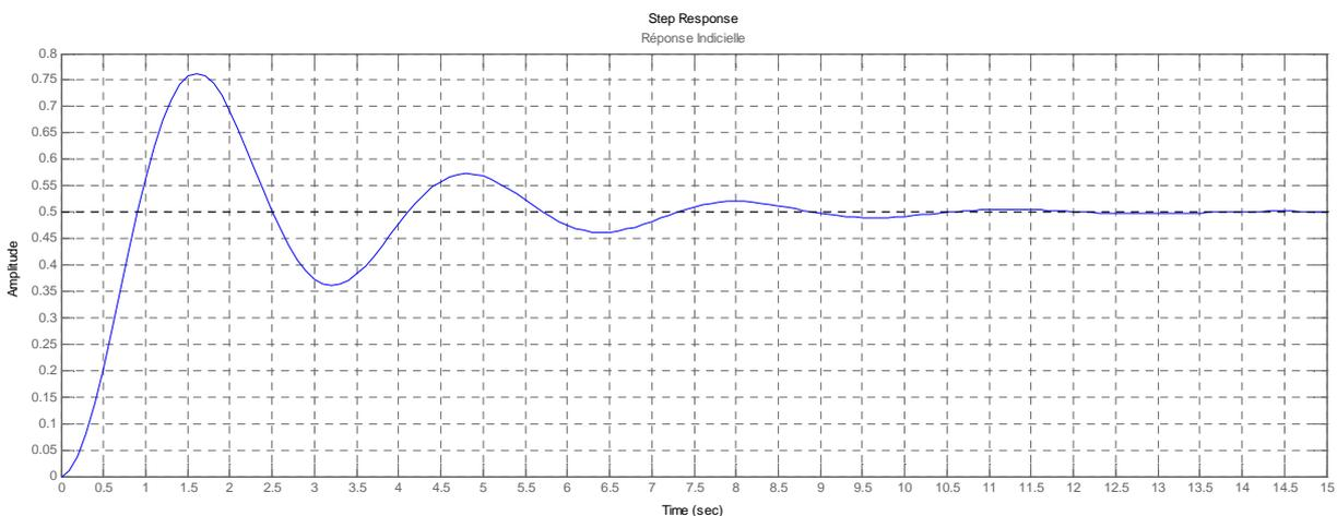
Soit, ci dessous, la réponse  $x(t)$  d'un système à un échelon d'entrée  $y(t)$  de 1%.
