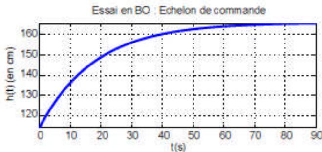
Essai en BO : Echelon de commande
