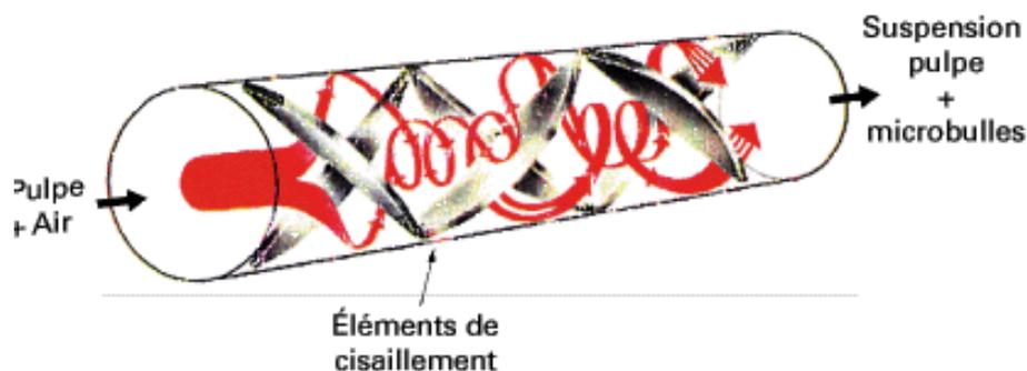
Figure 21 : Générateur-mélangeur de bulles Microcel-Control International
