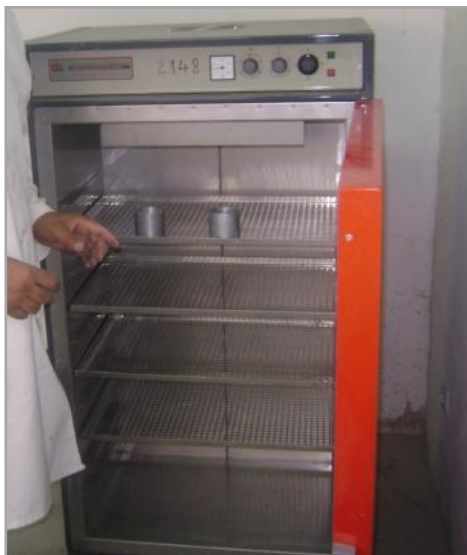
Etuve pour séchage des matériaux
