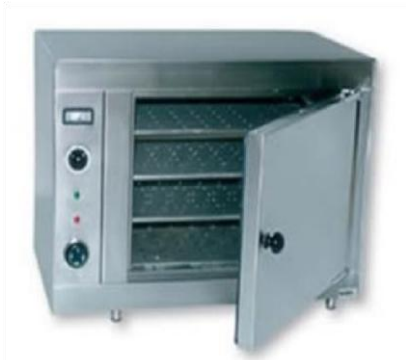
Étuve réglée à 105 \pm 5 °C pour sécher les granulats
