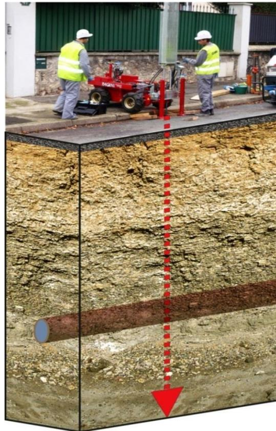
Mesure de l'état de compacité des sols au droit d'une canalisation enterrée.
