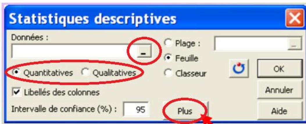
**Données** : sélectionner la plage des variables à décrire. S'il y a des valeurs manquantes dans une colonne, XLSTAT propose de les ignorer. En cas de refus, le traitement est abandonné.
